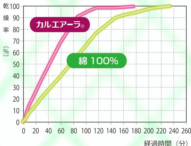
試料を水に30分浸漬後、家庭用洗濯機で2分脱水し、質量を測定。
