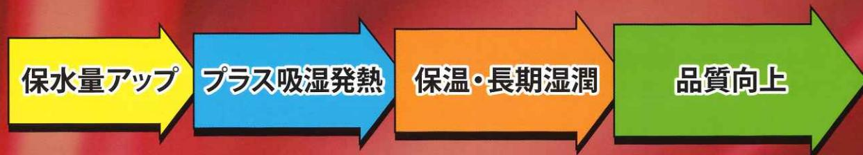
コンクリートの養生時には、品質を高めるため、硬化に必要な水和反応が促進されるように、できるだけ長く湿潤状態を保ち、かつ適度な温度を保つことがよいとされています。
